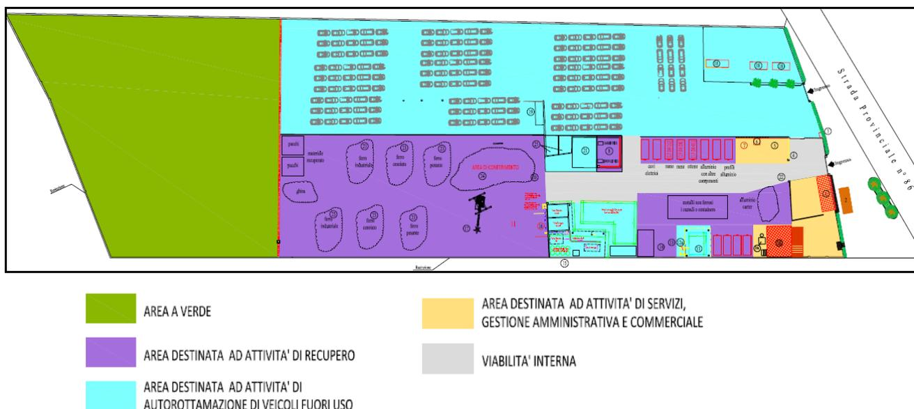
**Figura 8: Layout generale dell'impianto e dettaglio delle aree.**
