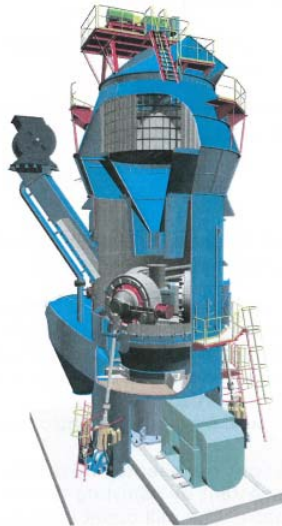
Figura 44: Nuovo mulino della farina per la produzione del clinker
