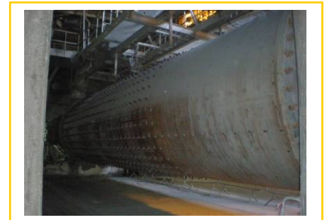
Figura 30: Impianto di macinazione cemento, mulino orizzontale a sfere
