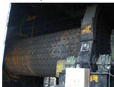
Figura 37: Mulino a sfere per la macinazione del Petcoke
