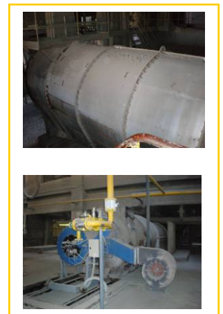
Figura 28: Impianto di essiccazione loppa umida, bruciatore ed essiccatore Hazemag
