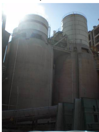
Figura 16: Sili della farina pronta all'introduzione nel forno
