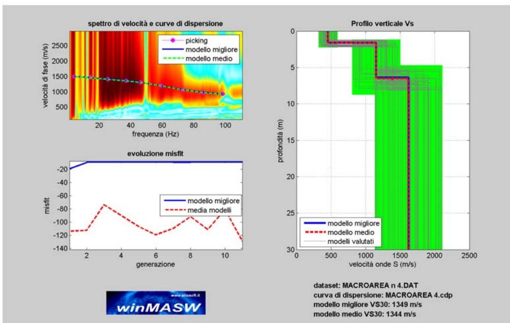
Allegato 4.5      Prospezione sismica tipo MASW - S5
