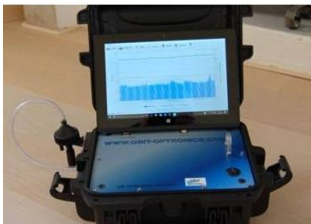
Figura 2: Sistema misura PM portatile LCT-14 della QBit
