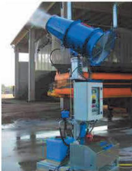
*Figura 7.4\_ Eempio di nebulizzatore mobile*
