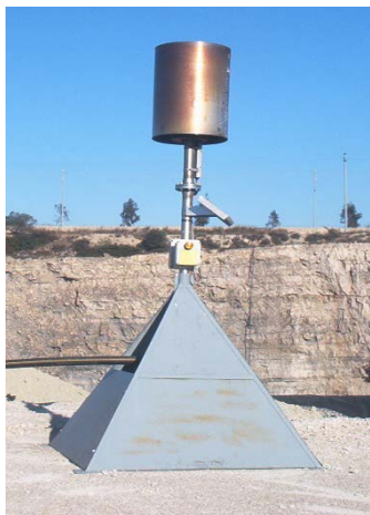
Torcia statica di combustione biogas con piedistallo (a sx) e torcia dinamica da 500 Nmc/h (a dx)
